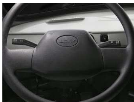
«Мягкое» рулевое колесо. Многофункциональные подрулевые переключатели
