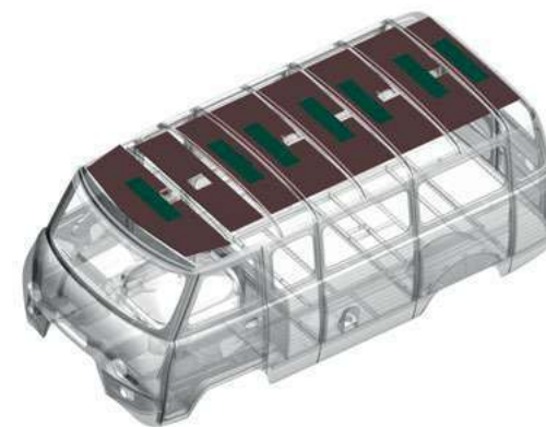
Иглопробивной материал обивки крыши
