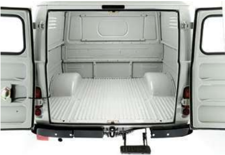
Распахнутые задние двери и малая погрузочная высота обеспечивает легкий доступ к грузовому отсеку. Ворсовая обивка салона
